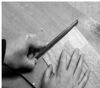
Vhodná poloha pilníku při broušení.
